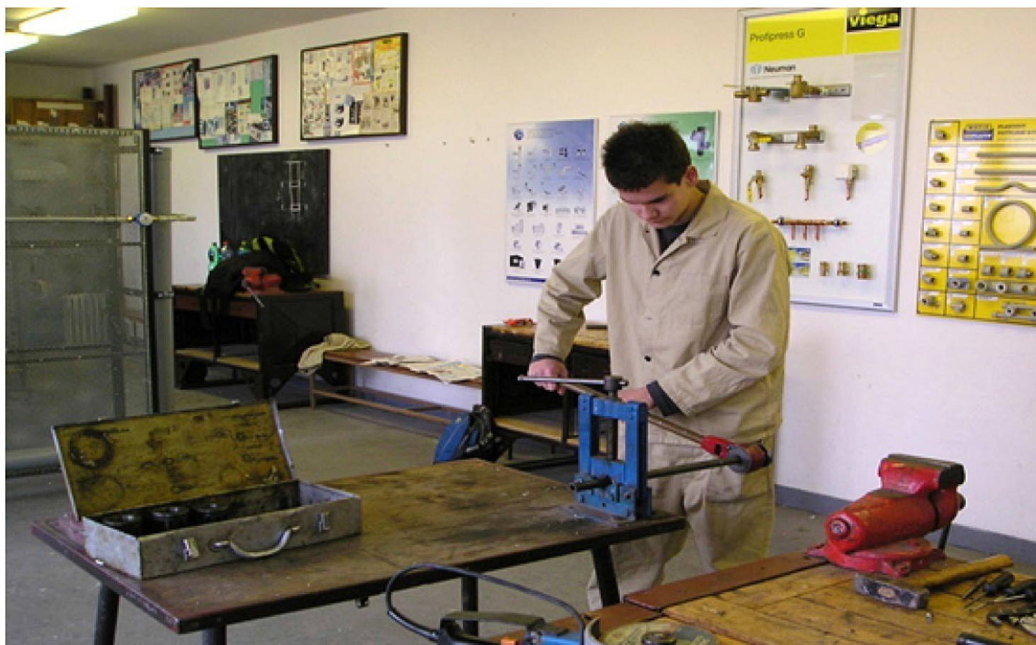
Řezání závitů na trubce ruční závitnicí
