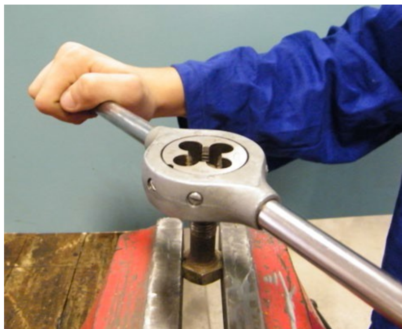
Řezání vnějších závitů (šroub)
